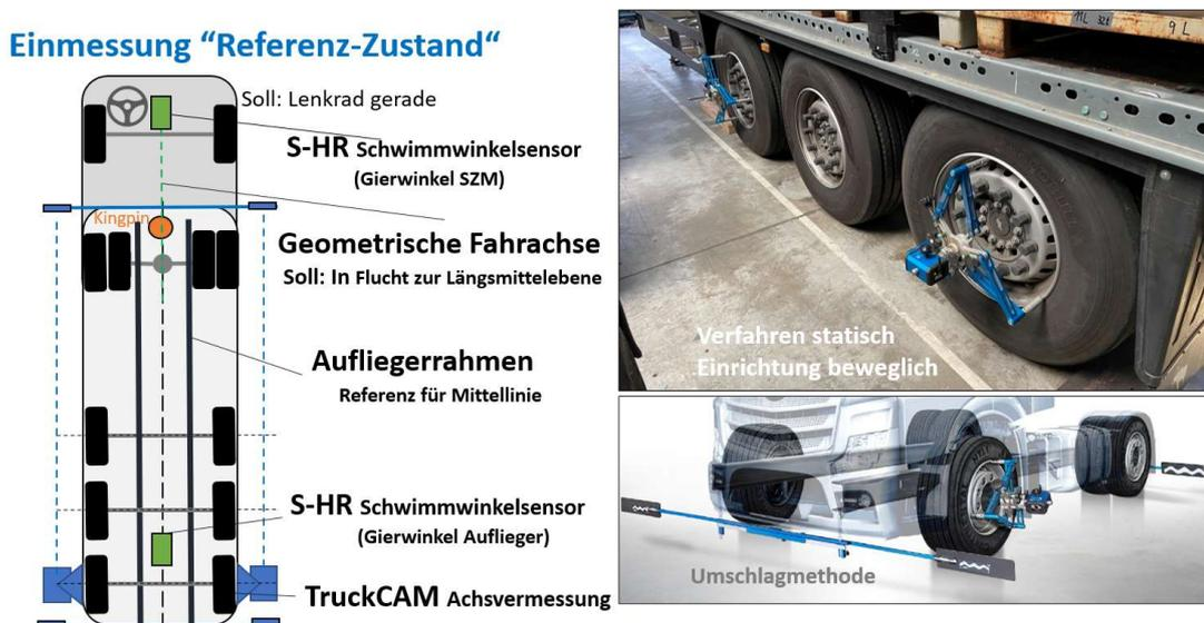
**Bild 19:** Vorgezogene stationäre Alignment-Untersuchung mit spezifischen Messeinrichtungen
